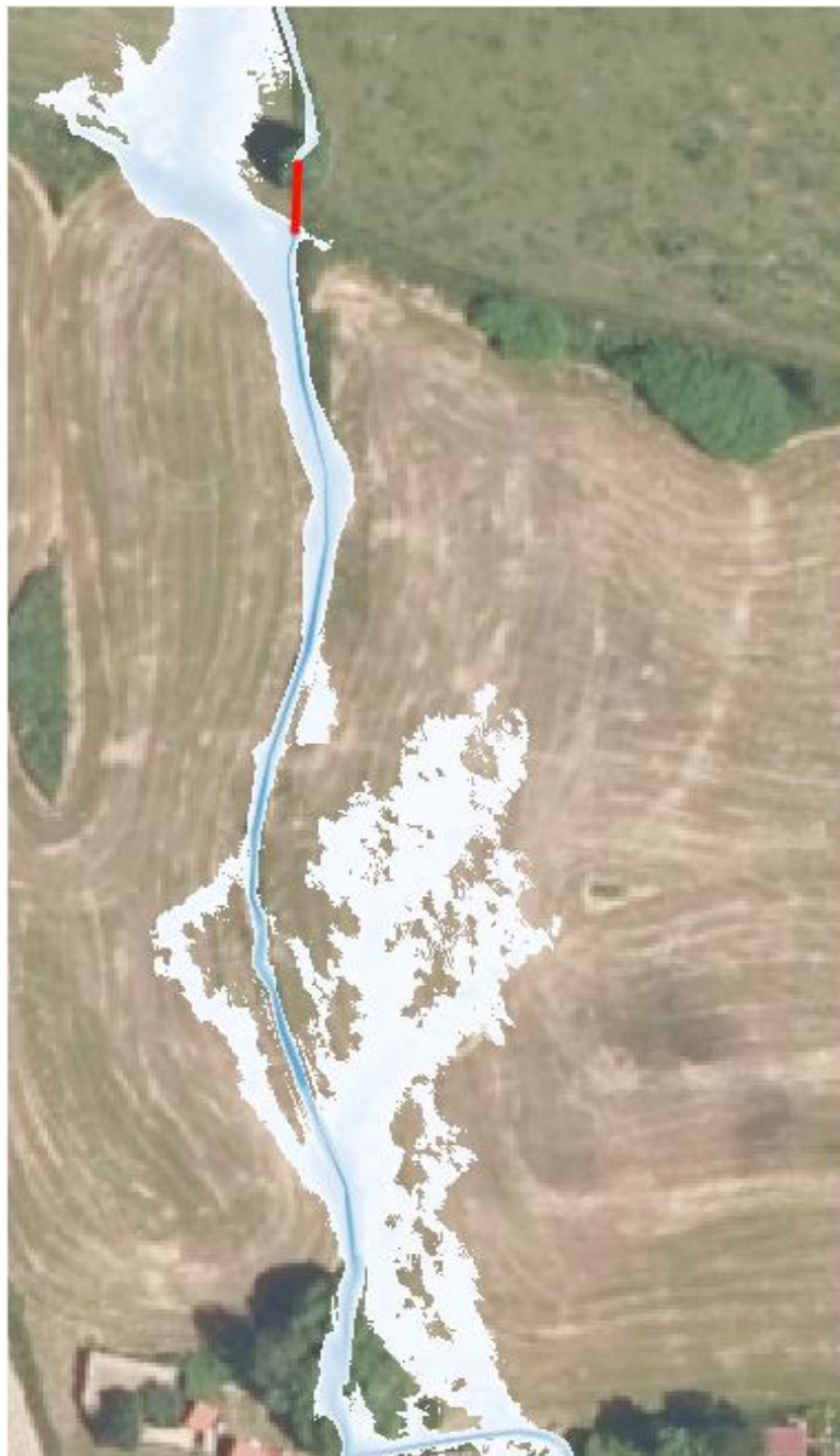
Abbildung 21: Wassertiefe HQ 100 lst-Zustand
