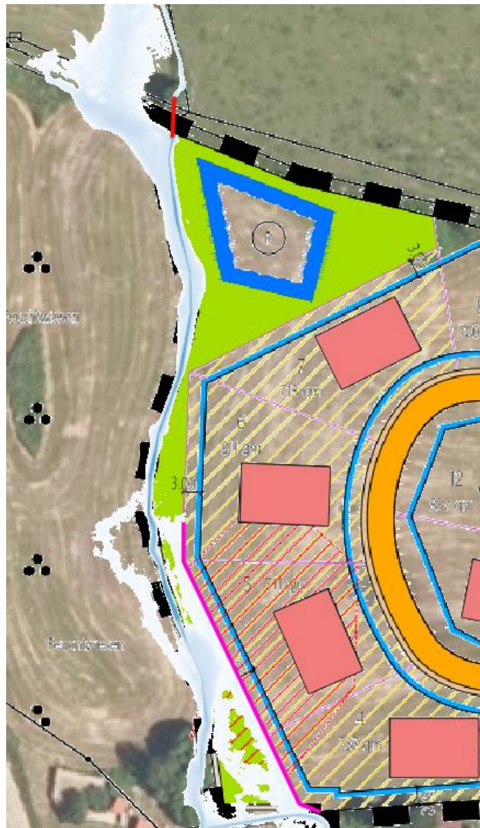
Abbildung 17: Wassertiefe HQ 100 Geplanter-Zustand (Bereich Baugebiet), Beginn Geländemodellierung (magenta)
