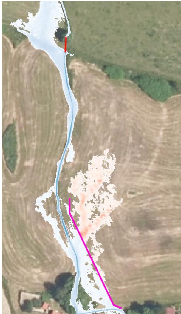
Abbildung 14: Wassertiefe HQ 100 Ist-Zustand inkl. Durchlässe (rot), Lage der Geländemodellierung (magenta) und „verlorenem“ Wasservolumen (Bereich Baugebiet)
