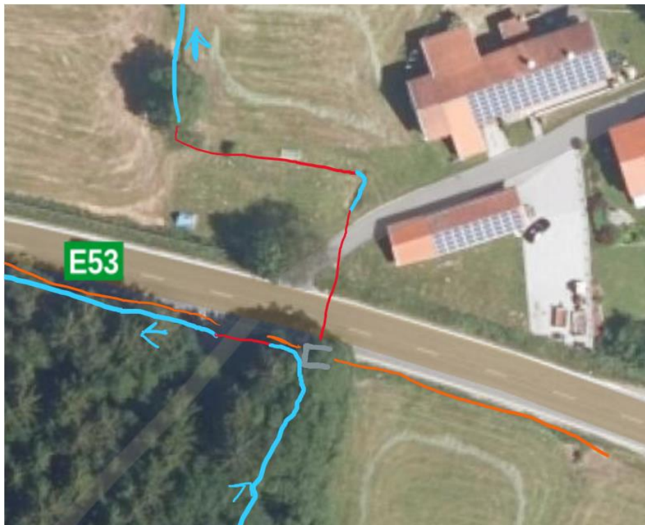
Abbildung 5: Skizze Abflussaufteilung Durchlass B85
