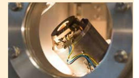
Die Quelle bzw. die Ionenkanone; im unteren Bereich (hinter dem Lochgitter) findet die Beschleunigung des Argon Plasmas statt; im oberen Bereich (wo die Drähte enden) wird das Plasma elektrisch neutralisiert
