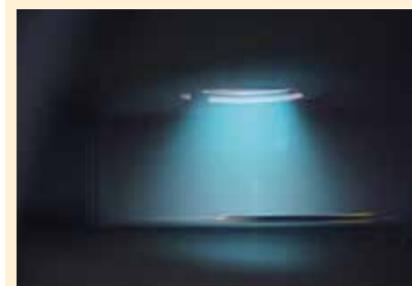
Aluminiumoxid (Al<sub>2</sub>O<sub>3</sub>) Plasma Abscheidung auf CFK
